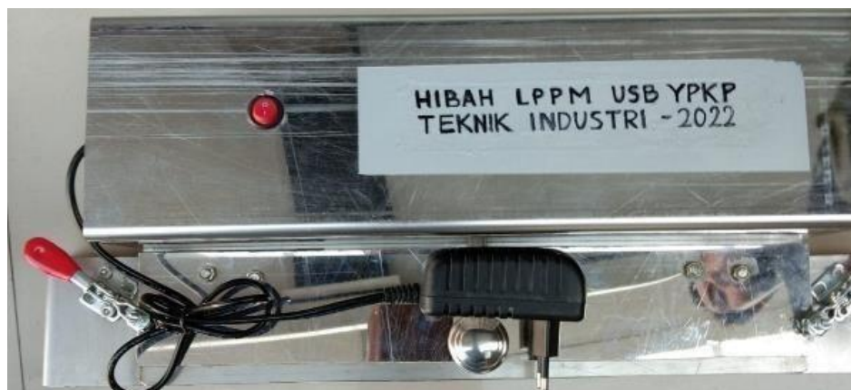
Gambar 4: Rancangan dan Prototype Mesin Vacuum Pendamping Sealer Versi 1
