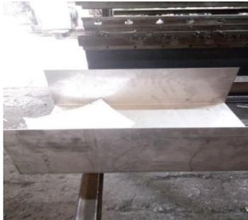
**Gambar 13.** Proses penekukkan atau bending
