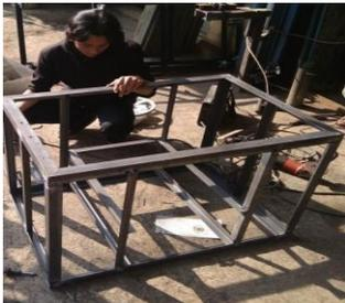
**Gambar 6.** Proses pembuatan rangka
