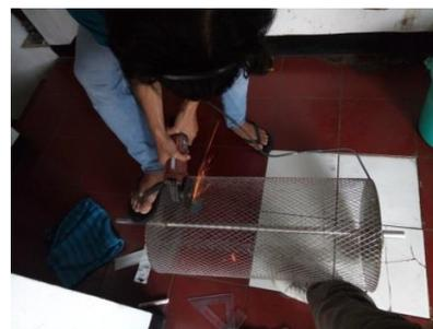
**Gambar 4.** Proses pembuatan pintu pada tabung pengupas bawang merah
