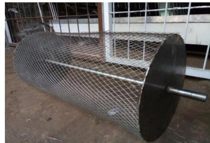
**Gambar 3.** Kawat loket yang sudah dilas ke plat lingkaran
