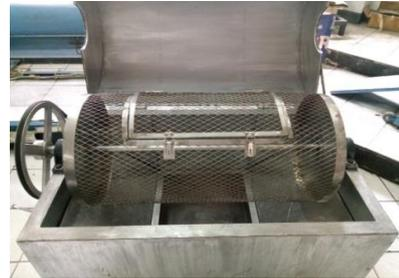
**Gambar 15.** Mesin pengupas bawang merah
