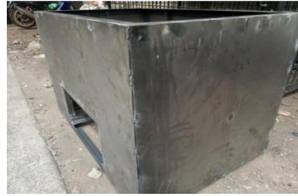
**Gambar 8.** Plat besi yang sudah dilas ke rangka
