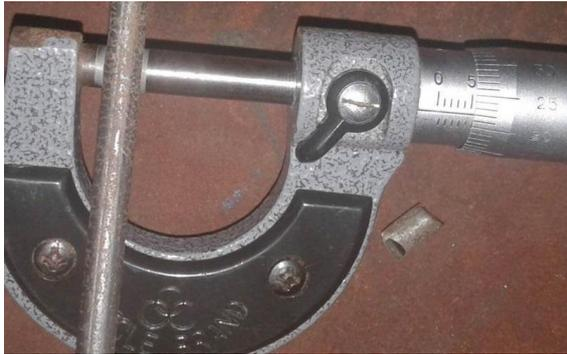
Gambar 5. Kawat dengan diameter 5 mm
