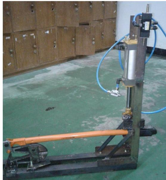
Gambar 9. Hasil pembuatan alat potong kawat kedua dengan penambahan *quick exhaust*
