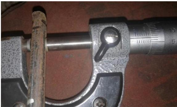
Gambar 6. Kawat dengan diameter 6 mm
