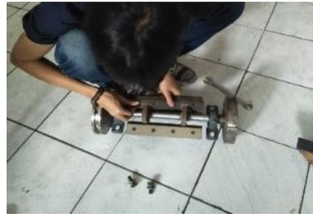
Gambar 12. Pemasangan baud pada pisau
