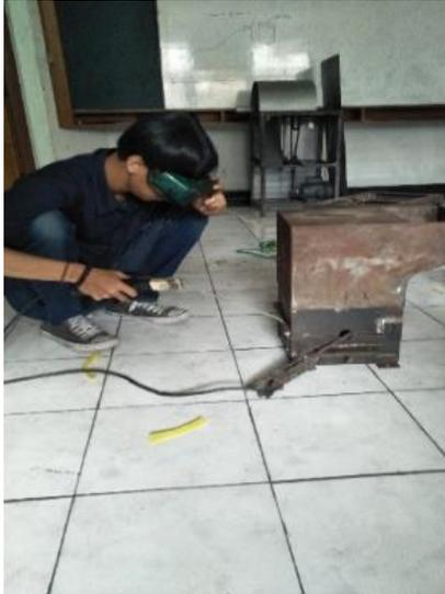
**Gambar 14.** Penyambungan rumah pencacah plastik dengan dudukan saringan
