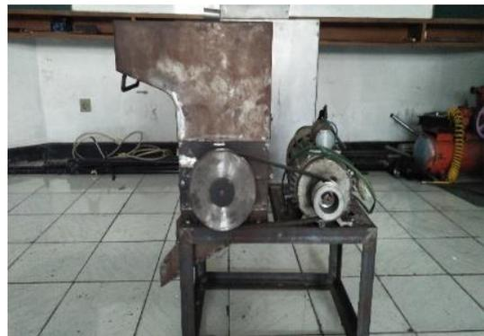
**Gambar 15.** Mesin pencacah plastik
