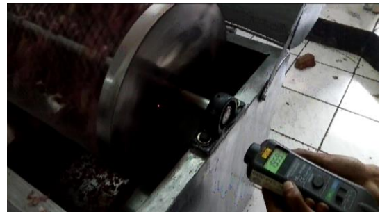
Gambar 4. Proses Pencatatan RPM Menggunakan Tachometer
