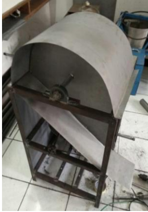
Gambar 12. Pemasangan Sekat Penampungan
