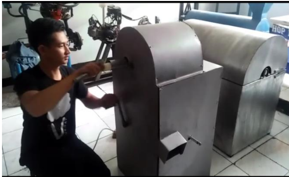
Gambar 30. Proses Perajangan Manual
