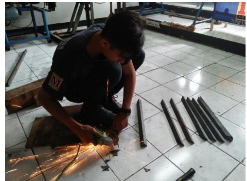
Gambar 3. Proses Pemotongan Besi Siku Menggunakan Gerinda Tangan
