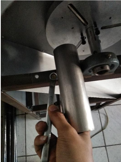
Gambar 22. Pemasangan Corong Dudukan Singkong Pada Rangka
