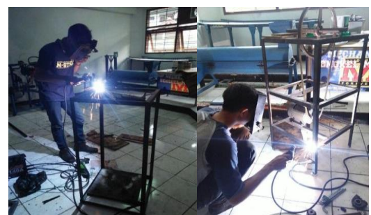
Gambar 4. Proses Pengelasan Rangka Menggunakan Mesin Las SMAW
