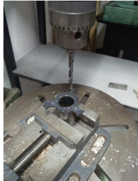
Gambar 7. Proses Pengeboran Dudukan Piringan
