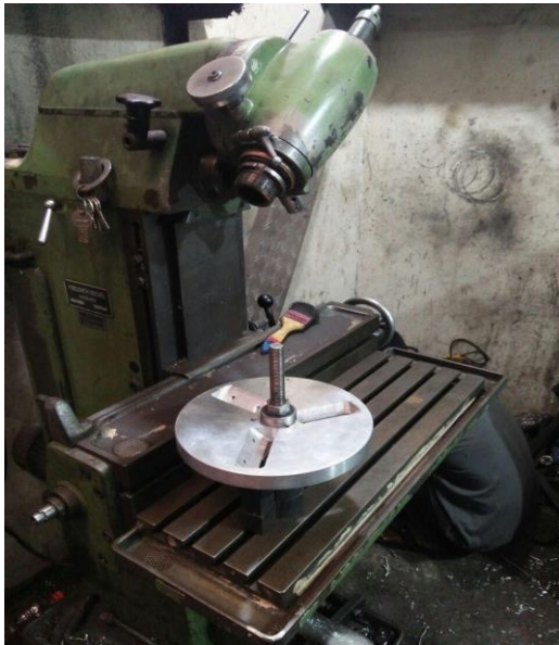
Gambar 5. Proses Pembubutan Piringan
