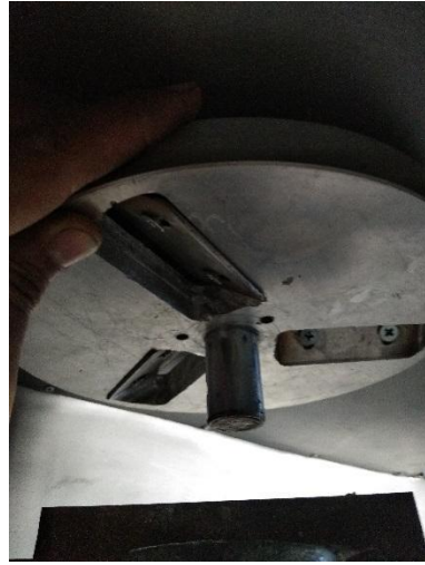
Gambar 15. Pemasangan piringan dudukan pisau Pada Poros
