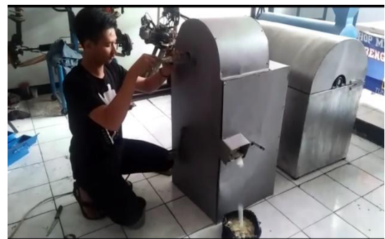
Gambar 28. Proses Perajangan Otomatis
