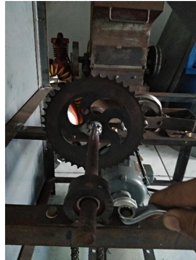
Gambar 20. Pemasangan Gear Besar Dan Bearing Transmisi Manual
