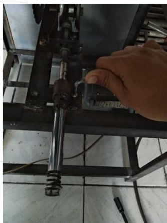
Gambar 19. Pemasangan Setelan Tensioner V-Belt
