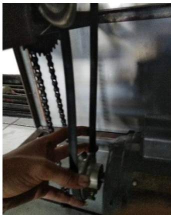
Gambar 18. Pemasangan V – Belt Pada Pully
