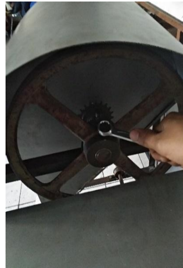
Gambar 16. Pemasangan Pully Besar
