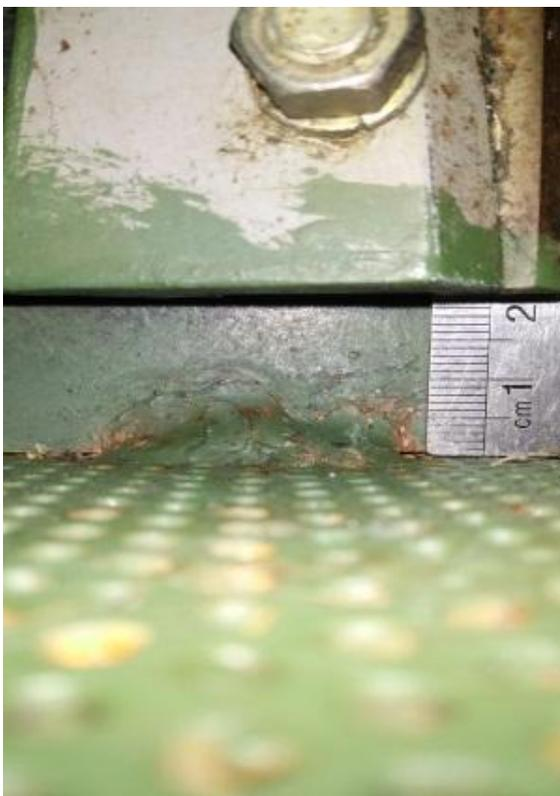
Gambar 4. Jarak pisau dengan permukaan (saringan air)
