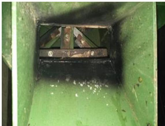
Gambar 8. Hopper output yang sudah dimodifikasi
