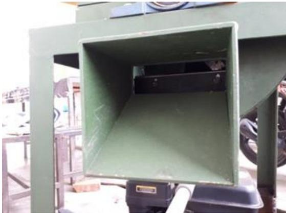
Gambar 7. Hopper output sebelum dimodifikasi.
