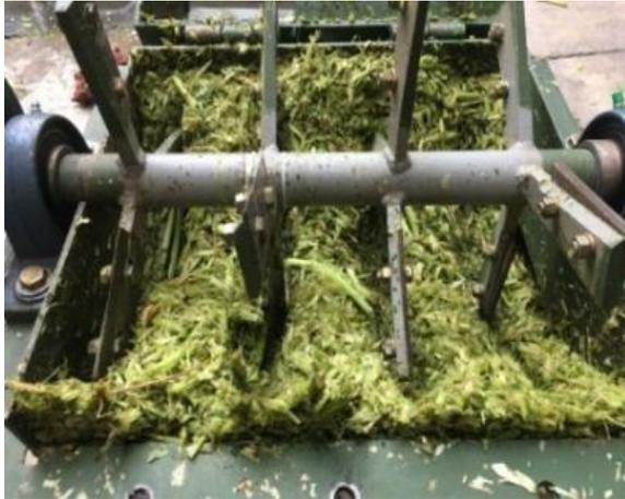
Gambar 3 Sampah yang menumpuk dalam mesin
