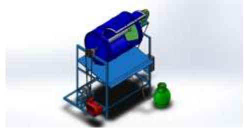
Gambar 2. Desain alat mesin pengering padi sistem rotary (Sumber Penulis)
