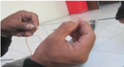
**Gambar 6: Serat Optik yang Masih Dibungkus Cladding**
