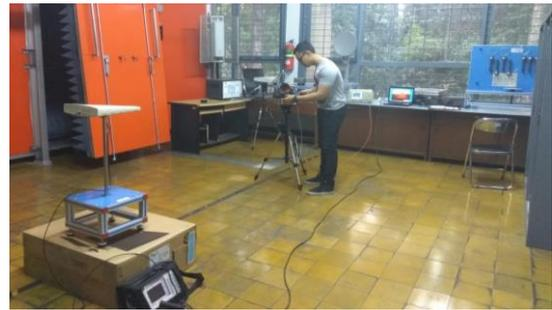
**Gambar 3.6** Pengukuran pola radiasi dan *gain* antenna bumbung gelombang sirkular frekuensi 2,4 GHz menggunakan *signal generator* dan *spectrum analyzer*
