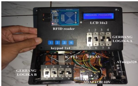
Gambar 9: Perancangan Perangkat Keras
