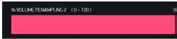
Gambar 10: Tampilan level air bak penampung pada Blynk
