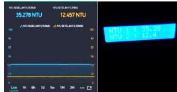
Gambar 9: Pengujian monitoring kekeruhan air (a) tampilan aplikasi, (b) tampilan LCD
