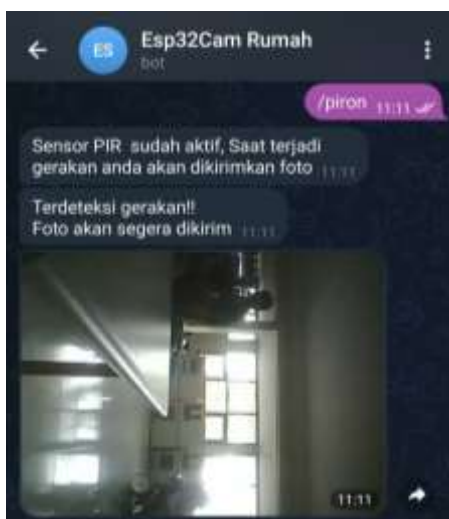
Gambar 6: Sensor PIR Mendeteksi Gerakan Dan C Mengirimkan Foto
