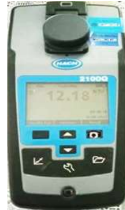
Gambar 8: Proses pengukuran menggunakan turbidity meter
