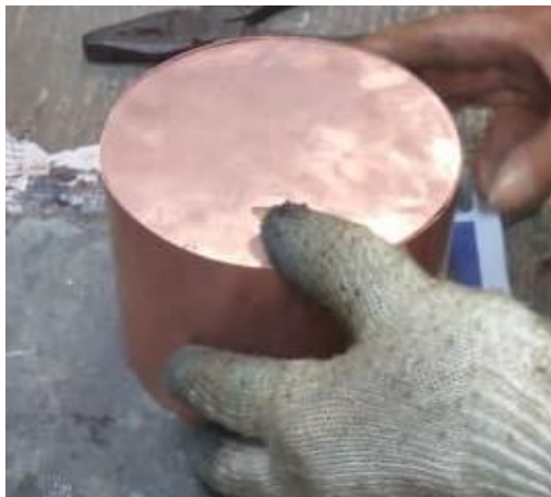
Gambar 3. 1 Hasil pabrikasi antenna bumbung gelombang sirkular pada frekuensi 2,4 GHz
