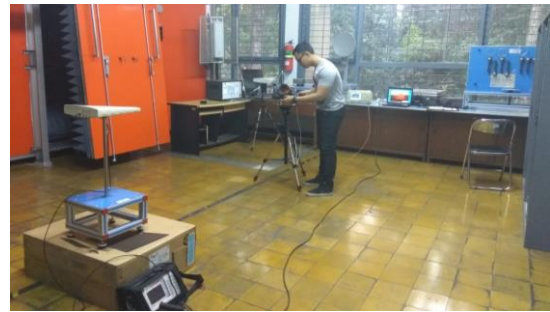
Gambar 3. 6 Pengukuran pola radiasi dan gain antenna bumbung gelombang sirkular frekuensi 2,4 GHz menggunakan signal generator dan spectrum analyzer
