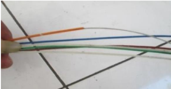
Gambar 5: Kabel Fiber Optik yang Sudah Dikupas
