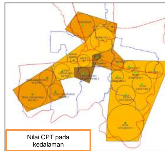
Gambar 22: Peta konsistensi tanah berdasarkan nilai qc pada kedalaman 1 meter
