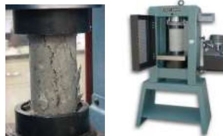
Gambar 2: Alat uji kuat tekan dan Benda Uji Tekan
