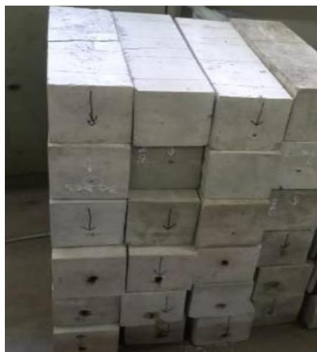
**Gambar 2: Benda uji balok beton**
