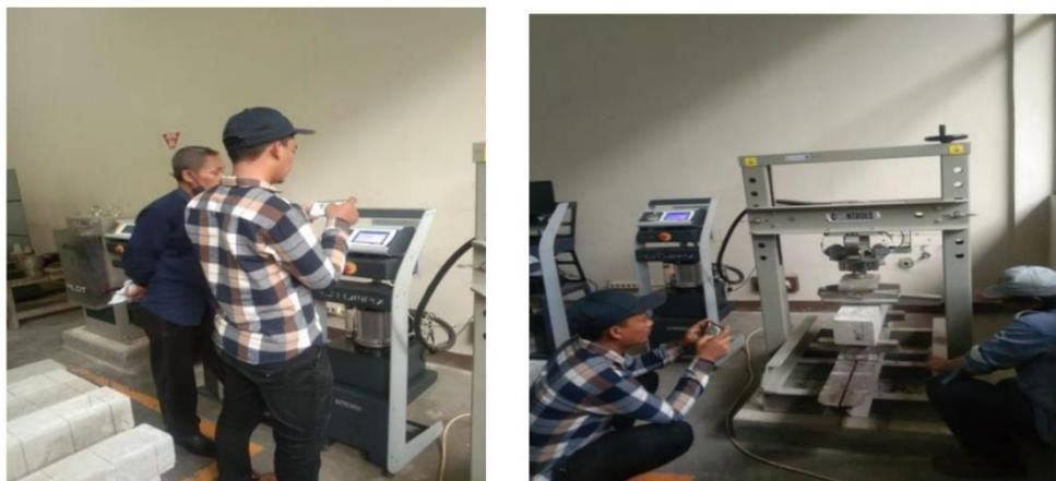
Gambar 4: Pengujian kuat lentur balok
