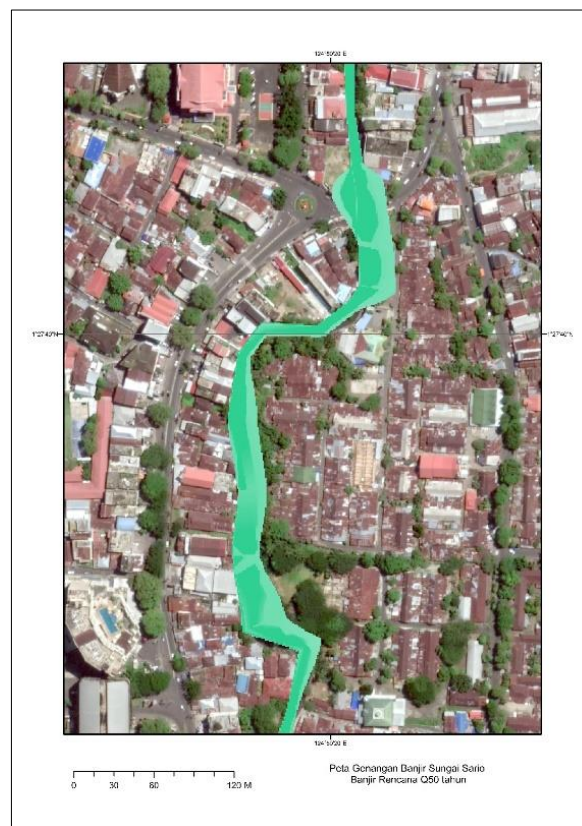
Gambar 15 : Genangan Sungai Sario Kondisi Eksisting Ruas 3
