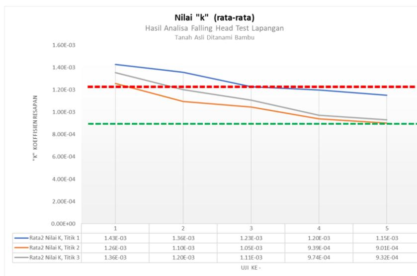
**Gambar 14: Ilustrasi hasil analisa nilai koefisien resapan terhadap pengujian pertama falling head di lapangan, untuk tanah asli yang ditanami bambu**
