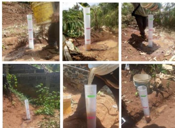
**Gambar 9: Dokumentasi Pengujian Falling Head di Lapangan**
