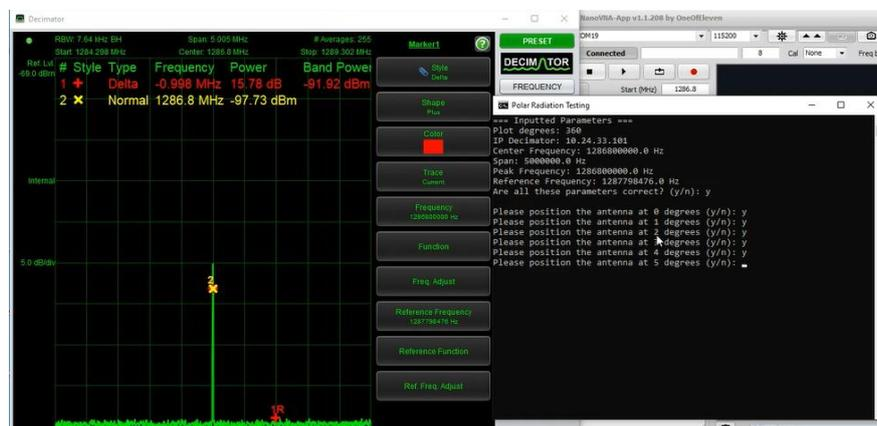
Gambar 12: Sinyal dan Aplikasi *Ploting* Azimut
