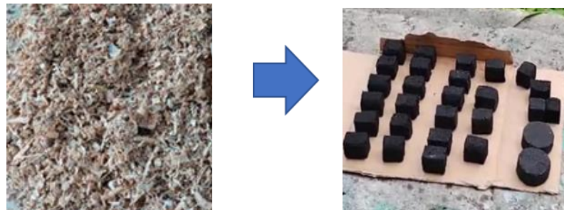
Gambar 2: Limbah Kayu Diubah Menjadi Arang Briket
