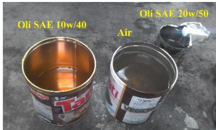
Gambar 3: 3 Media Pendingin Quenching Oli SAE 10w/40, Oli SAE 20w/50, dan Air
