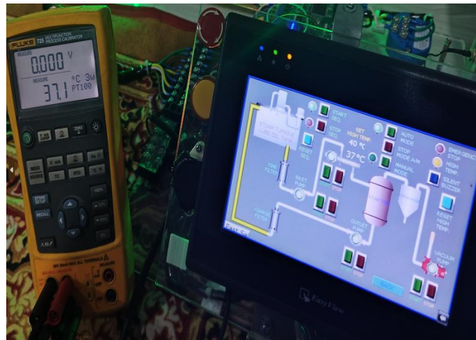
Gambar 10: Sistem Operasi Mesin Purifikasi Bisa Digunakan Kembali Saat Suhu Di bawah 40°C
